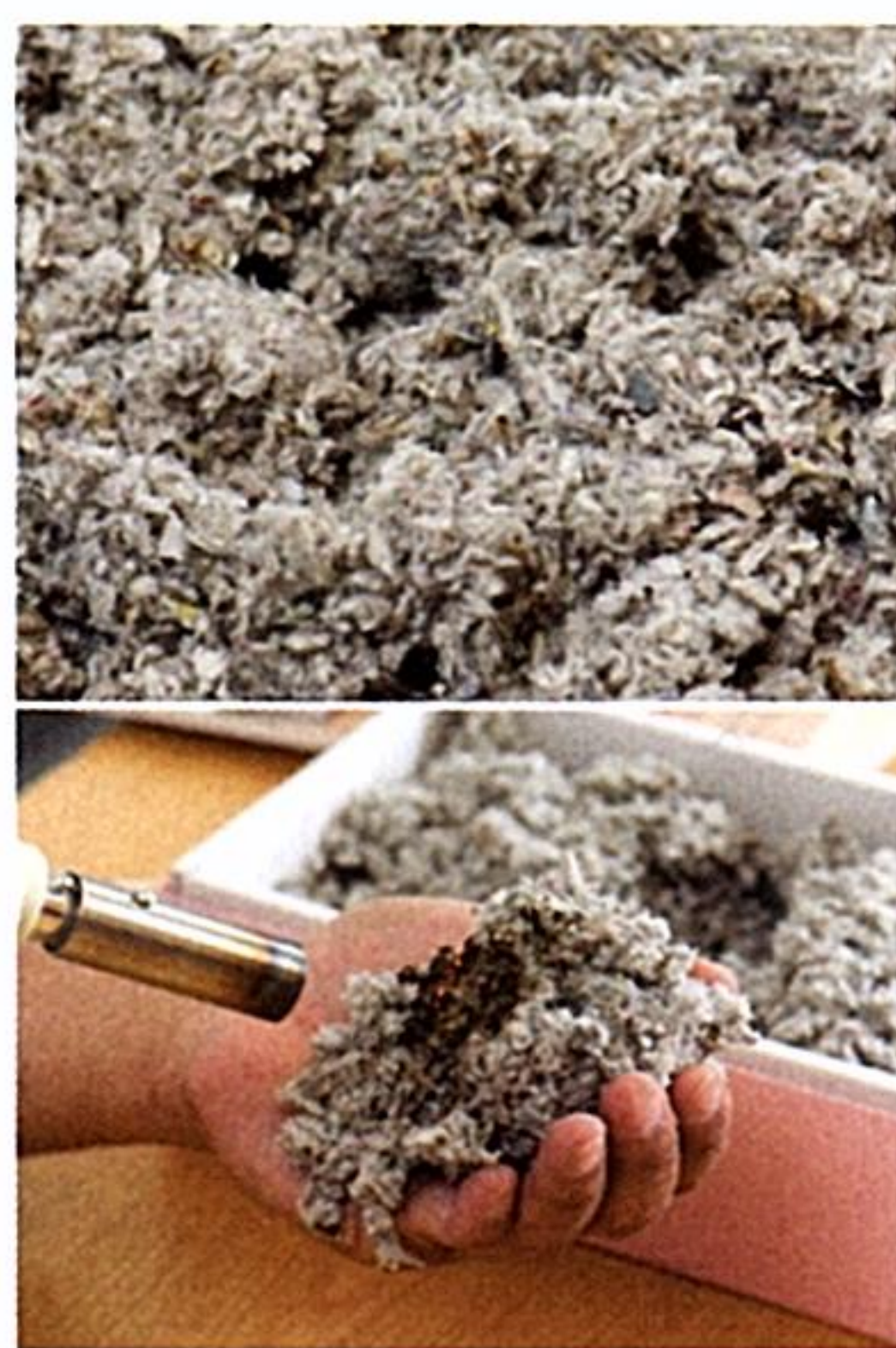
セルローズファイバーは、ホウ酸を使っていて火を当てると水が出るので火が広がりにくい。だが、無機繊維系の物よりも高価である。（火をつける実験は危険ですので、行わないでください。）
